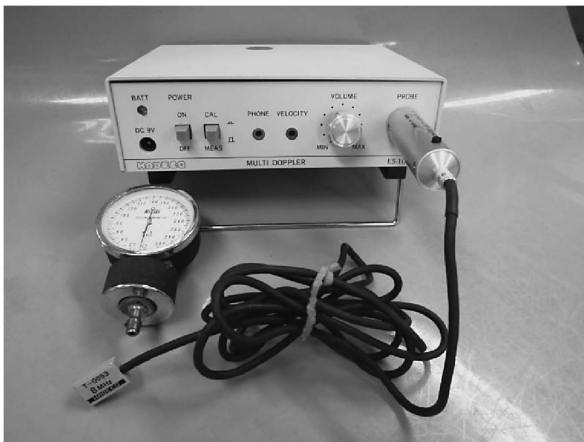
製品名：ES-107PZ 使用時期：1990年代 用途：非観血式血圧計 (手術中の血圧モニター)
